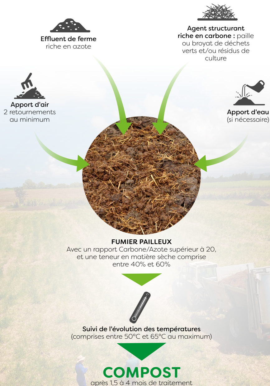
Figure n°1 : LES GRANDS PRINCIPES DU COMPOSTAGE DES EFFLUENTS DE FERME.
