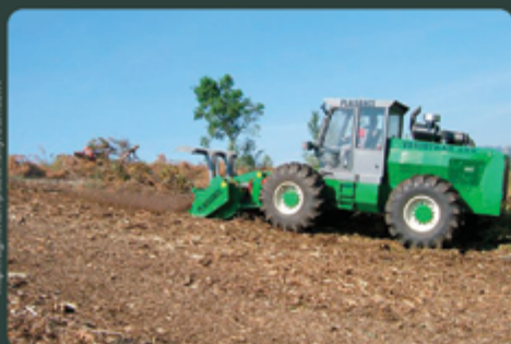
Broyeur automoteur Plaisance en plein travail de broyage des résidus sur une parcelle défrichée
