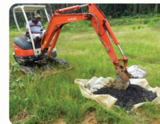
Broyage du charbon à la pelle mécanique
